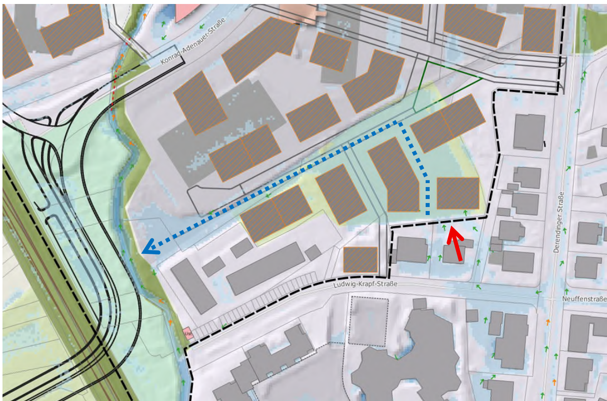
Abbildung 9: geplante Bebauung zwischen Konrad-Adenauer- und Ludwig-Krapf-Straße mit maximalen Überflutungstiefen und Fließgeschwindigkeiten eines außergewöhnlichen Starkregenszenarios
