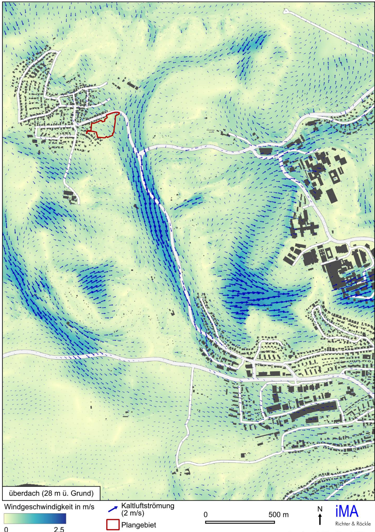
Abbildung 4-6: Übergeordneter nächtlicher Kaltluftabfluss zwischen Hagelloch und Tübingen-West. Das Plangebiet wird rot umrandet dargestellt.
