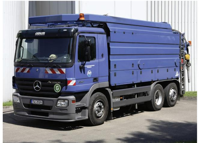
Abbildung 5: Kanalspülfahrzeug
