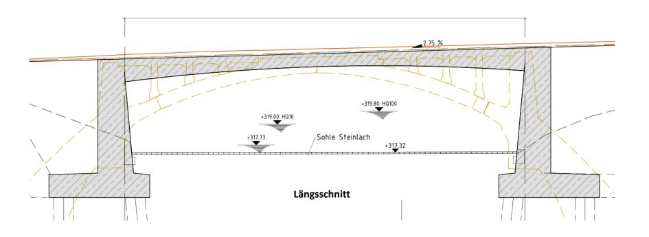
Von der Stadtverwaltung empfohlener Entwurf: Rahmenbrücke aus Spannbeton. Die Bruttobaukosten liegen geschätzt bei 1,5 Mio €. Hinzu kommen Abrisskosten der alten Brücke, Planungskosten, Verkehrsumleitungskosten. Der Durchflussquerschnitt wird gegenüber der alten Brücke verbessert.
