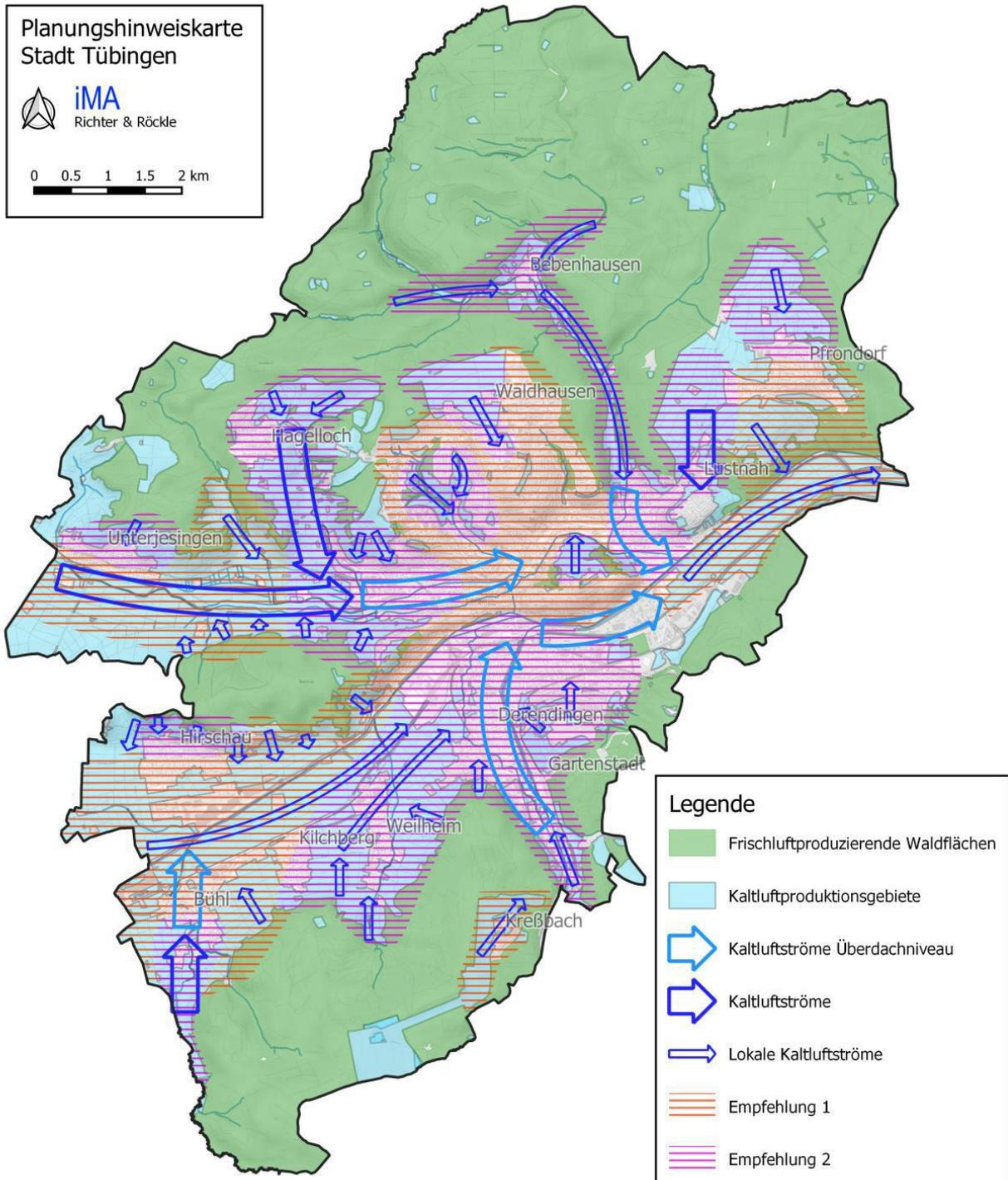
Planungshinweiskarte für die Kaltluftströmungen und deren Belüftungsfunktionen auf Basis der Erkenntnisse aus der gesamtstädtischen Kaltluftuntersuchung. Diese enthält folgende Bestandteile:
