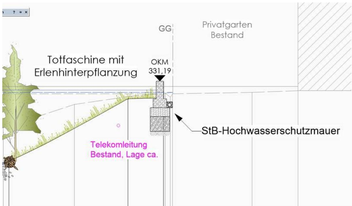
**Querprofil mit Mauer aus Ortbeton**
