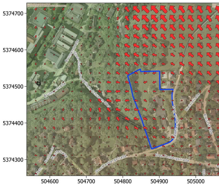
Abb. 4-2: Kaltluft-Strömungsverhältnisse des Screening-Modells GAK, Auswertung etwa 30 min nach Beginn einer Kaltluftsituation. Das Plangebiet ist blau markiert (Luftbildgrundlage: onmaps.de © GeoBasis-DE/BKG 2021 © Hexagon).
