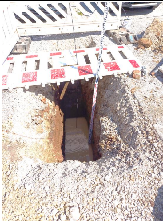
Foto Nr. 2 Versickerungsversuch SG1 – Ende 2,8 h
