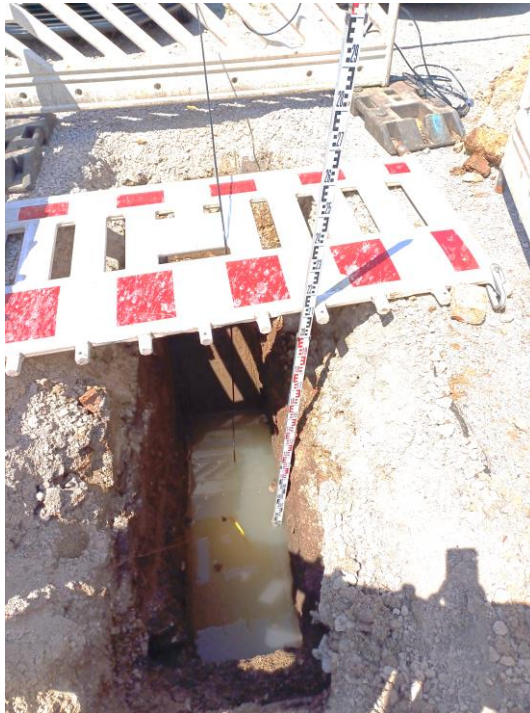
Foto Nr. 1 Versickerungsversuch SG1 - Beginn
