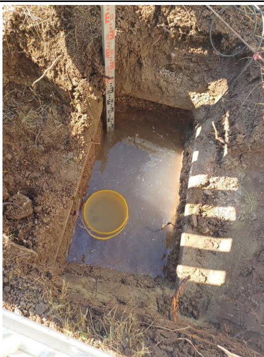
Foto Nr. 8 Versickerungsversuch SG4 – Ende 6,5 h
