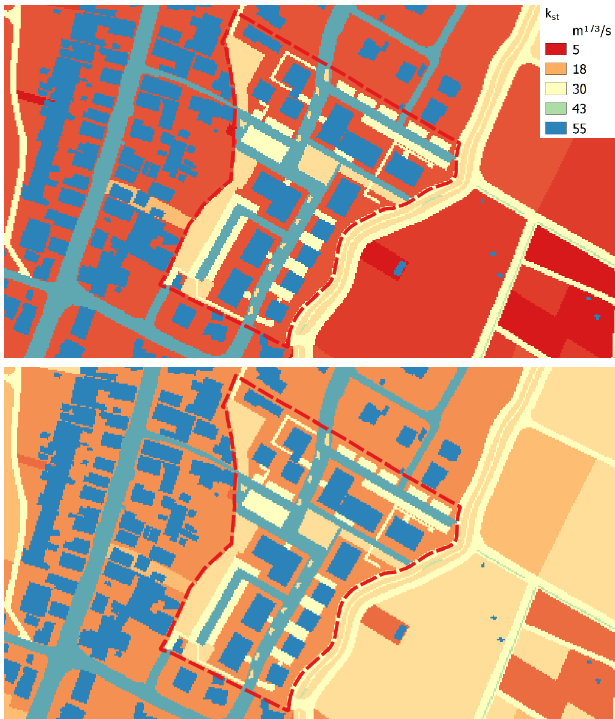
Abbildung 3: Neue Rauheiten BG „Hinter den Gärten“ für den 1. Planungsrechenlauf (oben: Dünnschichtabfluss bis 2 cm, unten: ab 10 cm Fließtiefe)
